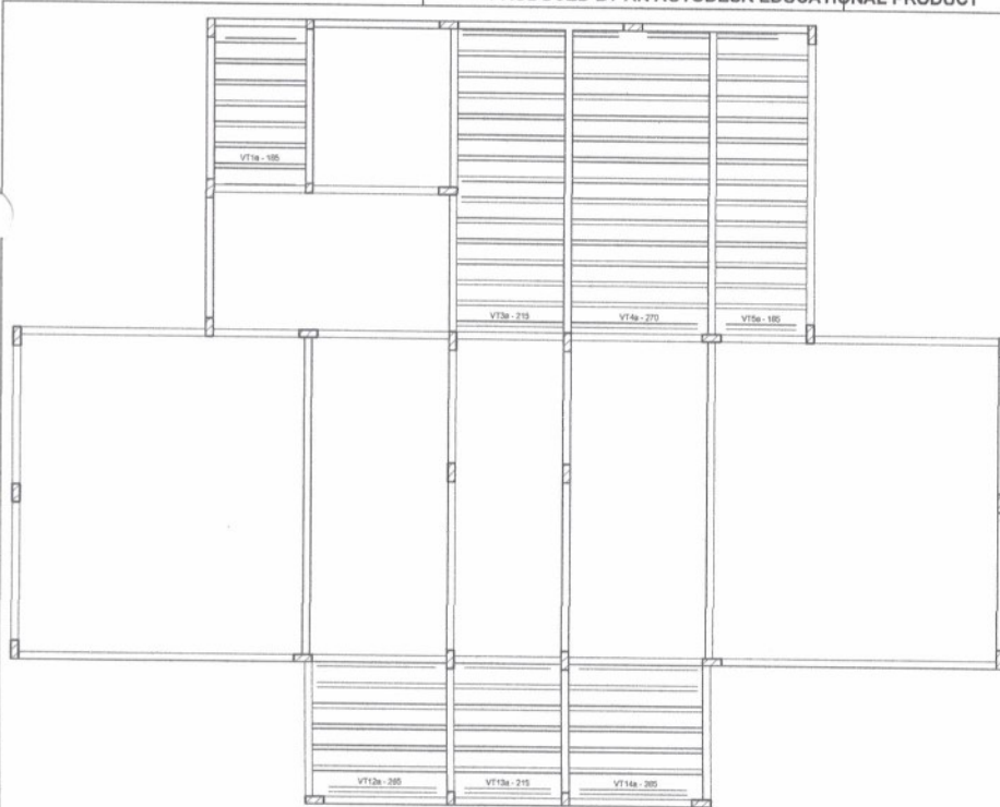
Planta de vigotas pré-moldadas escala 1:75
